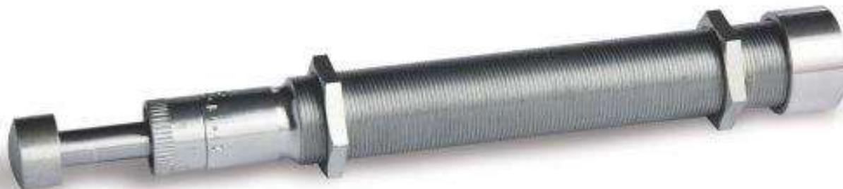
Die Ölbremse dient zur Geschwindigkeitseinstellung von pneumatischen Antriebseinheiten. Sie erzeugt über den gesamten Hub eine konstante Gegenkraft und sorgt so für eine konstante Geschwindigkeit z. B. bei Vorschubeinheiten zum Sägen, Bohren, Fräsen etc.. Auf Grund der geringen Baugröße ist sie vielseitig einsetzbar. Die patentierte Dosierkurve erlaubt eine feinfühligkeit der Geschwindigkeit ab 0,8 m/s.
