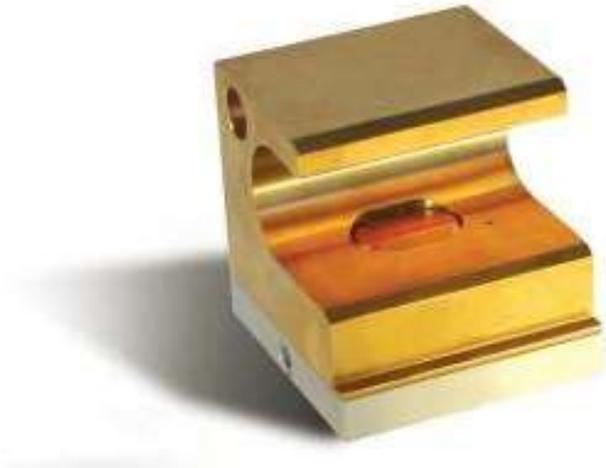
Die Führungswellenbremse wird zum Bremsen und Arretieren von Schlitten auf Führungswellen eingesetzt. Die Bremse wird am Schlitten montiert, die Welle läuft durch die unten offene Bohrung. Ein Messingbremsbacken wird pneumatisch gegen die Welle gepresst. Die Bremse wird in Varianten mit unterschiedlicher Bremskraft für Wellendurchmesser 25 gefertigt.
