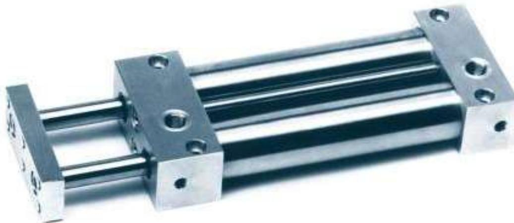
Der PKDZ ist eine kompakte Einheit aus zwei parallel verlaufenden Zylinderrohren und Kolbenstangen. Er ist daher hervorragend geeignet als Führungseinheit und zum Bau von Vorschubeinheiten. Er kann auch als Zylinder mit Verdrehsicherung eingesetzt werden.
