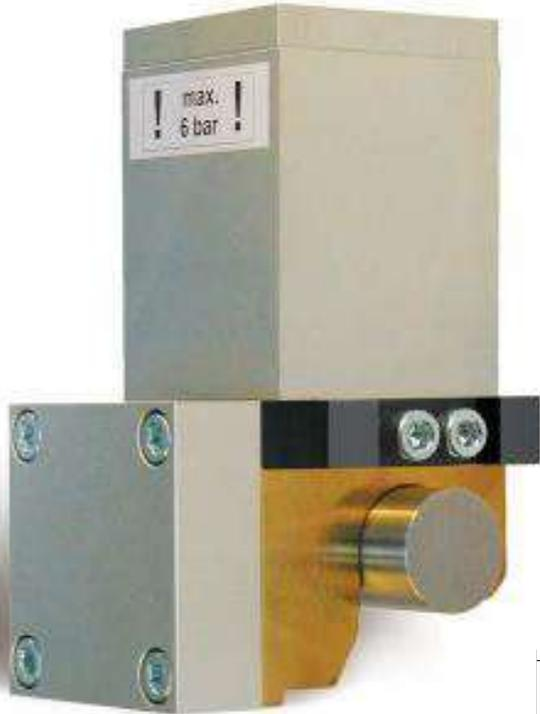
Bei dieser Führungswellenbremse wird die Bremskraft über ein Federpaket erzeugt. Zum Lösen der Bremse ist der Anschluss von Druckluft (6 bar) erforderlich. Die Montage erfolgt über eine flexible Befestigungslasche, die Fluchtungsfehler in zwei Achsrichtungen ausgleicht.
